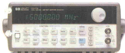
Der 15-MHz-Funktions-/Arbiträr-Generator HP 33120 A: Welche Wellenformen hätten Sie gern?
